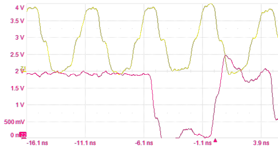
Abbildung 1: e.MMC-Schnittstelle bei 1,8 V und 200 MHz (gelb: CLK, rot: DAT0) mit deutlichen Reflexionen auf DAT0. Ob diese Über- und Unterschwinger auch an der Eingangsstufe auftreten, kann jedoch nicht beurteilt werden.
